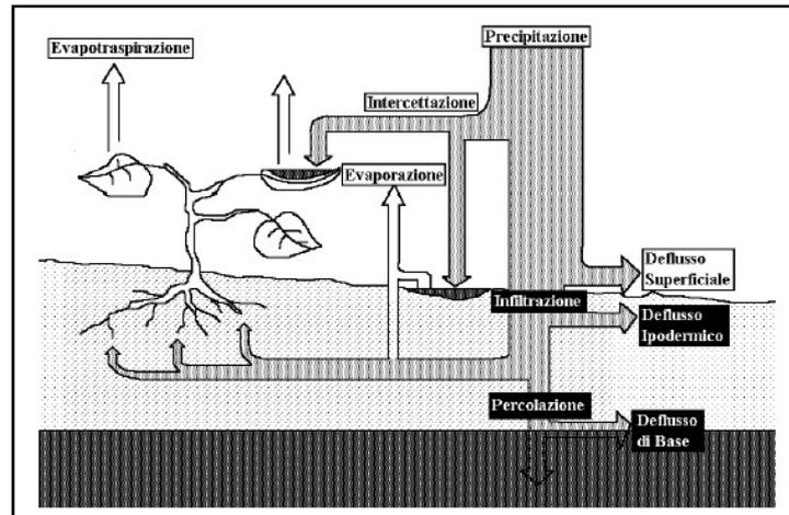
**Figura 1- Elementi che concorrono al bilancio idrologico del processo "afflussi-deflussi"**
