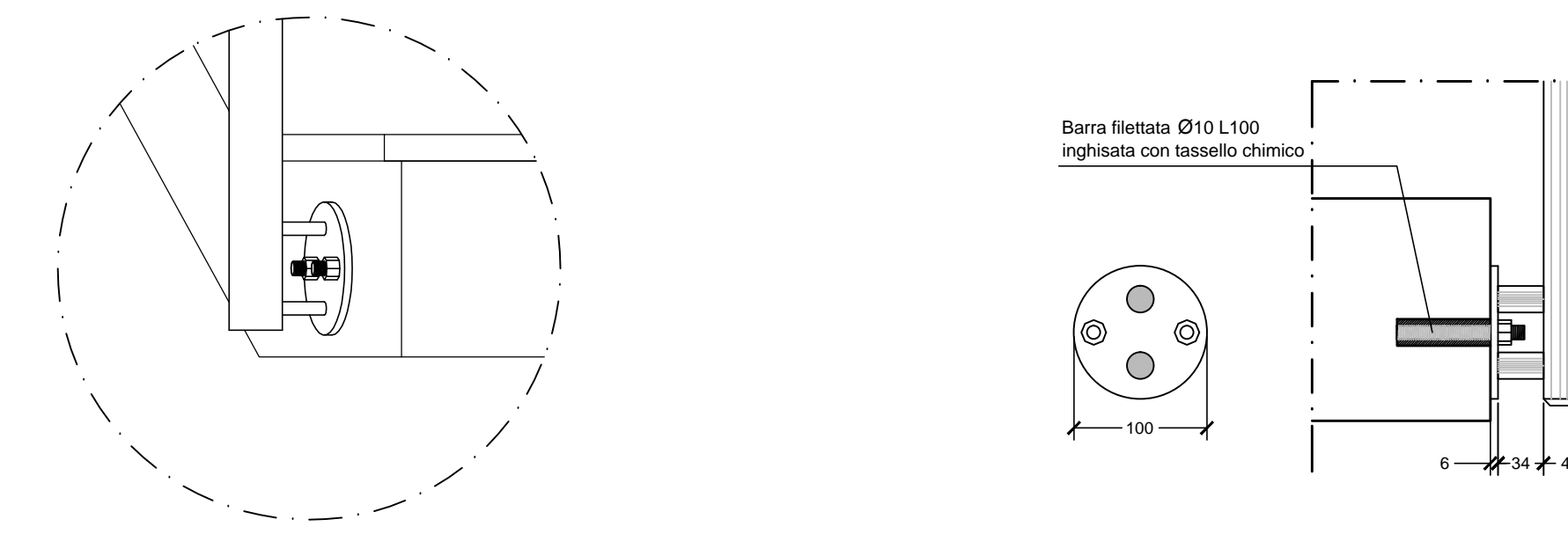
PARTICOLARE ATTACCO PARAPETTO RAMPA scala 1:5
